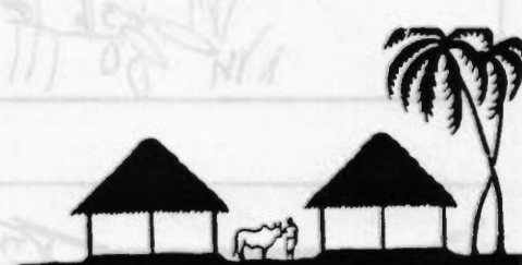
Enfoncer les poteaux dans le sol (environ 4 mètres) 3
