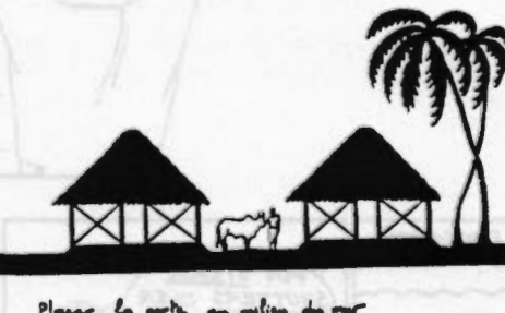
Placer la porte au milieu du mur renforcé par une croix de chaque côté de la porte. 8
